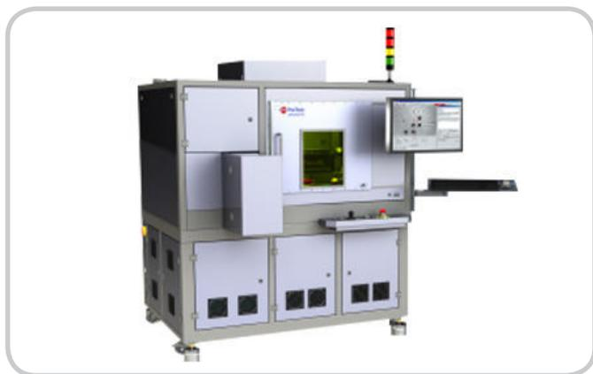
В установке LAPLACE-FC интегрированы механизмы монтажа флип-чипов и оплавления лазером, которые выполняются за один цикл. Сборка с применением лазера может применяться для пайки флип-чипов, а также для монтажа с использованием анизотропных проводящих пленок (ACF) или непроводящих полимеров (NCP). Система может быть дополнена модулем дозирования, с помощью которого наносятся флюс, паяльная паста, ACF или NCP.
