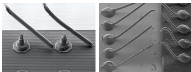
Рис. 9 – основные виды разрушений перемычек в ходе теста на отрыв. Слева показано разрушенные сварные перемычки, справа – перемычки SB2-WB
