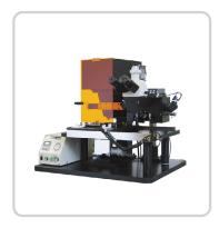
Установка совмещения и экспонирования ЕМА-400 предназначена для использования в лабораториях, исследовательских центрах, университетах для выполнения НИОКР и мелкосерийного производства. Это экономичное и компактное оборудование, обладающее высокими эксплуатационными характеристиками.
