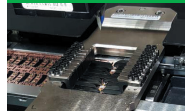
Блок зажима выводных рамок (усилие до 300 кг)
