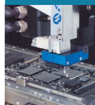
Дозирование подкристалльной заливки, кристаллы установлены на плату
