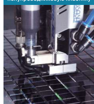
Дозирование подкристалльной заливки, кристаллы установлены на полупроводниковую пластину
