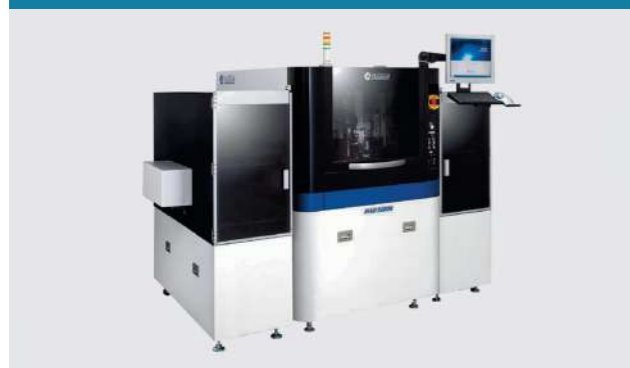
Дозирование подкристалльной заливки, кристаллы установлены на плату
