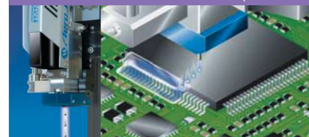
AeroJet, дозирующая головка для селективного бесконтактного точечного нанесения материала
